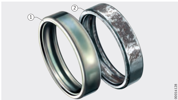
Рисунок 11 Кольца подшипников после испытания в солевом тумане
