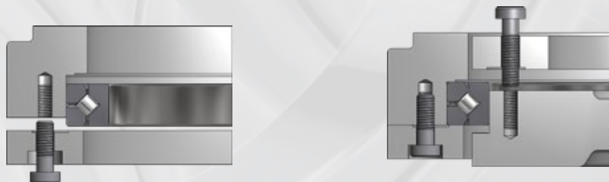
Befestigung von Kreuzrollenlager mit Klemmrings
